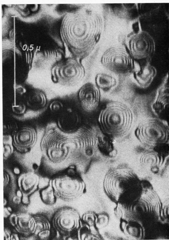
Abb. 5. Quer- und Parallelverkantungs-Moirés in Glimmerblasen bilden „NEWTONSche Ringe“, Dunkelfeld, (110)-Reflex.
